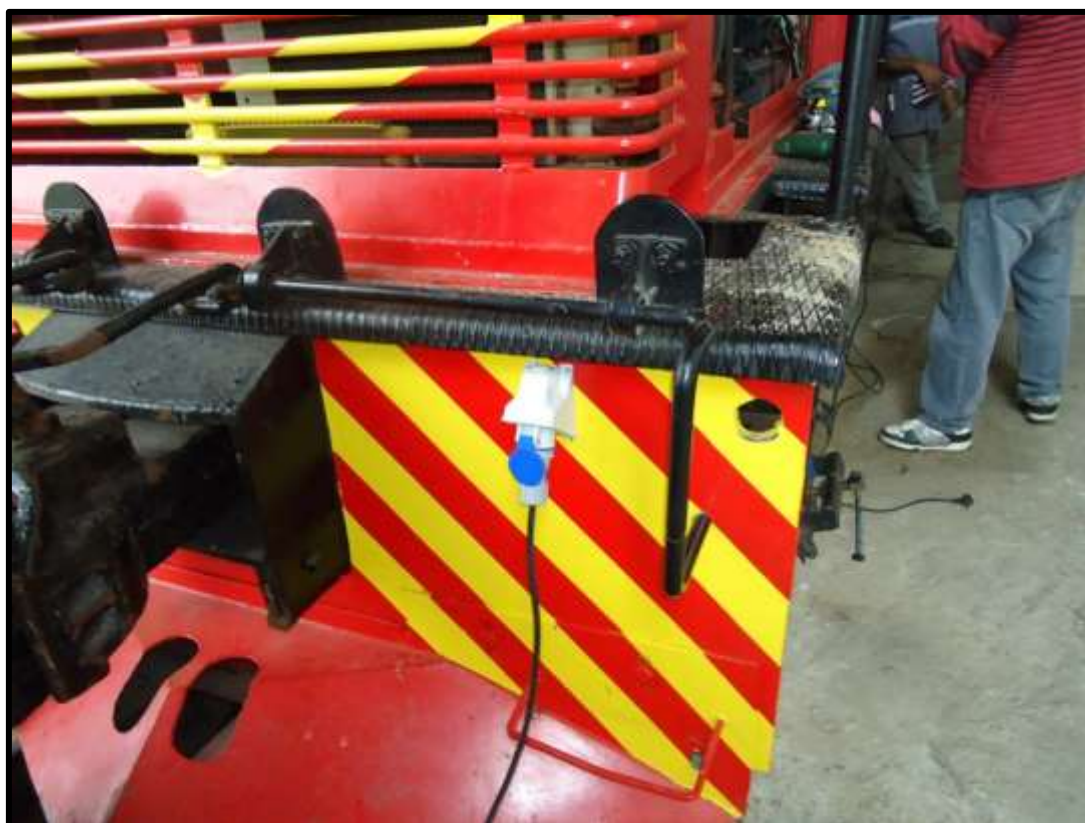
Acima: Instalação do inversor na locomotiva Francesa. Abaixo: Tomada de conexão na locomotiva Francesa.
