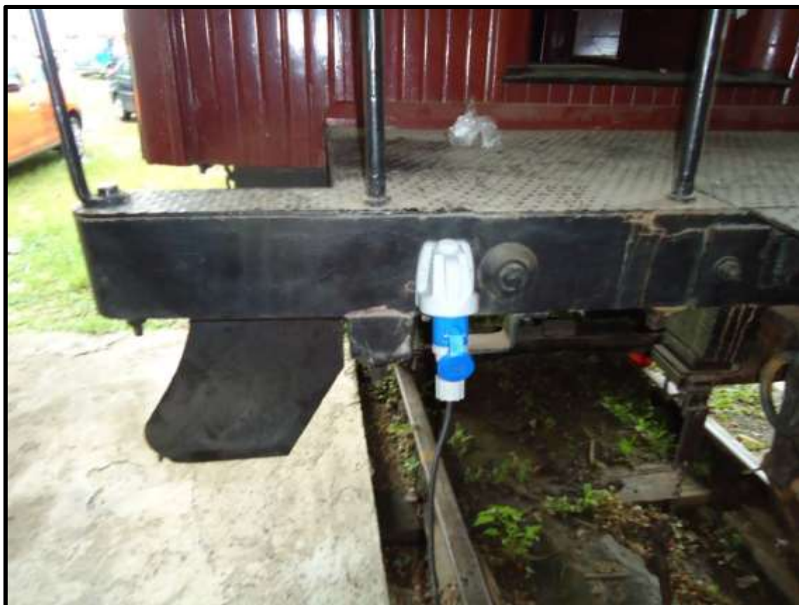
Acima: Tomada de conexão para energia elétrica no carro P-14. Abaixo: Manobra do P-14 nas oficinas de Curitiba.
