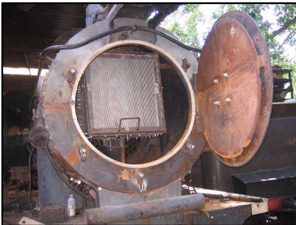
Acima: Novo detentor de fagulhas instalado na caixa de fumaça da locomotiva 9. Abaixo: Recuperação do interior do tênder da locomotiva 9. Fotos: Hélio Gazetta Filho.
