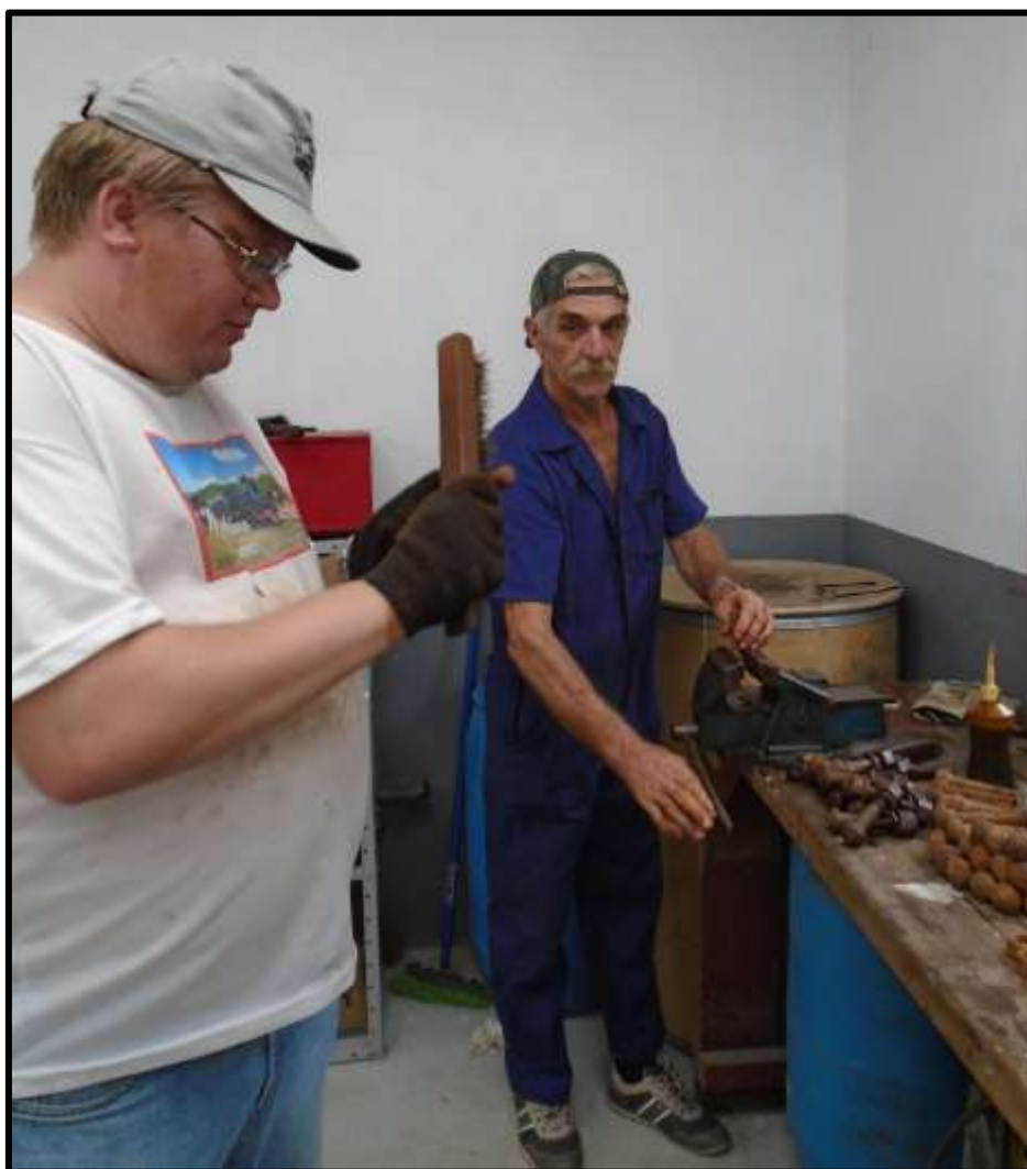
Os associados Marcelo Frotscher, a esquerda, e Osni Klabunde em trabalho de retificação de porcas e parafusos de tala, trabalho imprescindível para a sobrevivência do quase centenário material ferroviário utilizado na revitalização da EFSC. Foto: Luiz Carlos Henkels em 21/02/2015.
