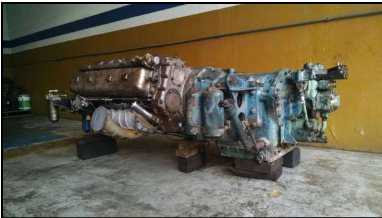
Acima: Primeiro conjunto motor-transmissão da litorina após recuperação.
