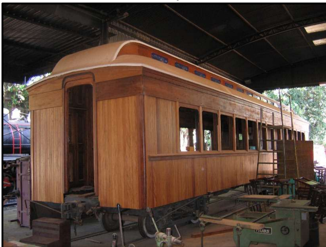
Acima: Novo piso do carroCA-35 oriundo da NOB. Abaixo: Carro R-1 da CMEF em restauração nas Oficinas de Carlos Gomes. Fotos: Hélio Gazetta Filho.
