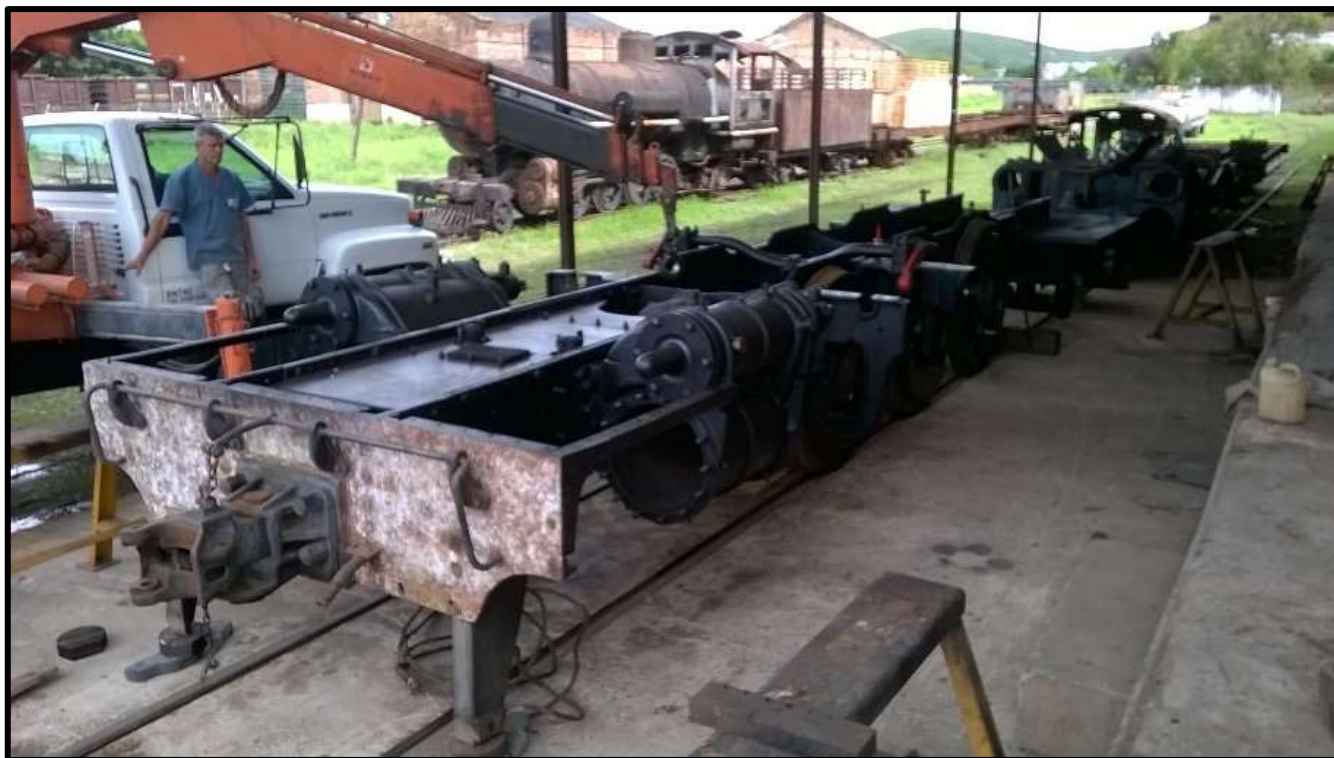
Longeirão da locomotiva 327 sendo recuperado em Cruzeiro-SP.
