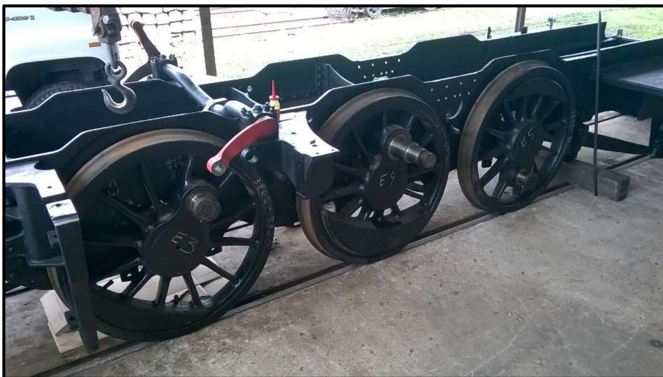
Longeirão da locomotiva 327 sendo recuperado em Cruzeiro-SP.
